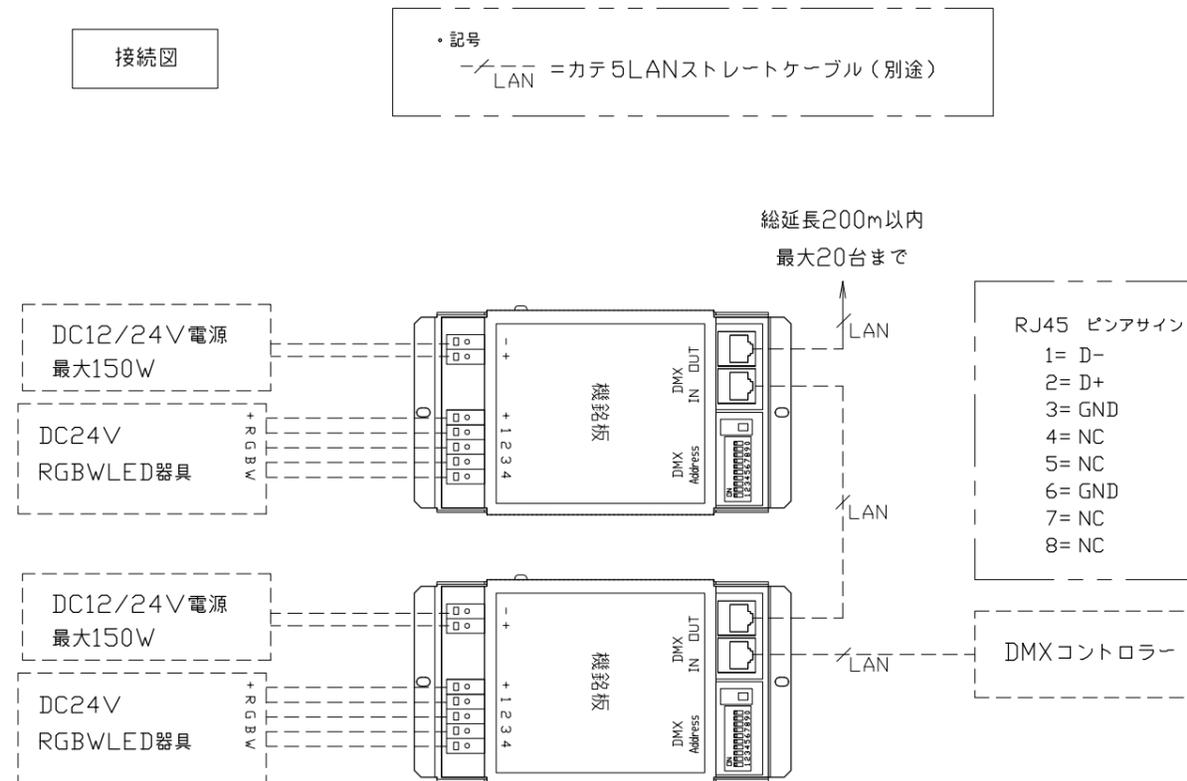
※DMXは最大延長距離200m以内、最大接続台数20台迄です。超える場合はDMX増幅器を使用してください。
